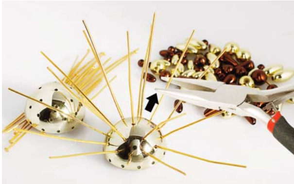
Beispiel für von innen eingeführte und nach außen gezogene Nietstifte
